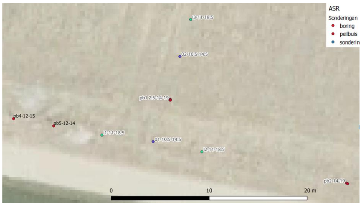
Figuur 8 Overzicht puttenveld en monitoringspeilbuizen.
