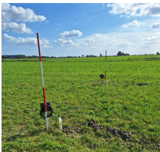
Figuur 21 twee locaties met peilbuis en bodemsensoren
